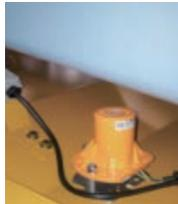
작업대 상승 상태에서의 주행을 방지하기 위한 안전장치(작업대 상승 상태 시 주행속도를 자동 제한하거나 차단함)
