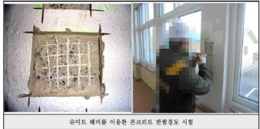
슈미트 해머를 이용한 콘크리트 반발경도 시험
