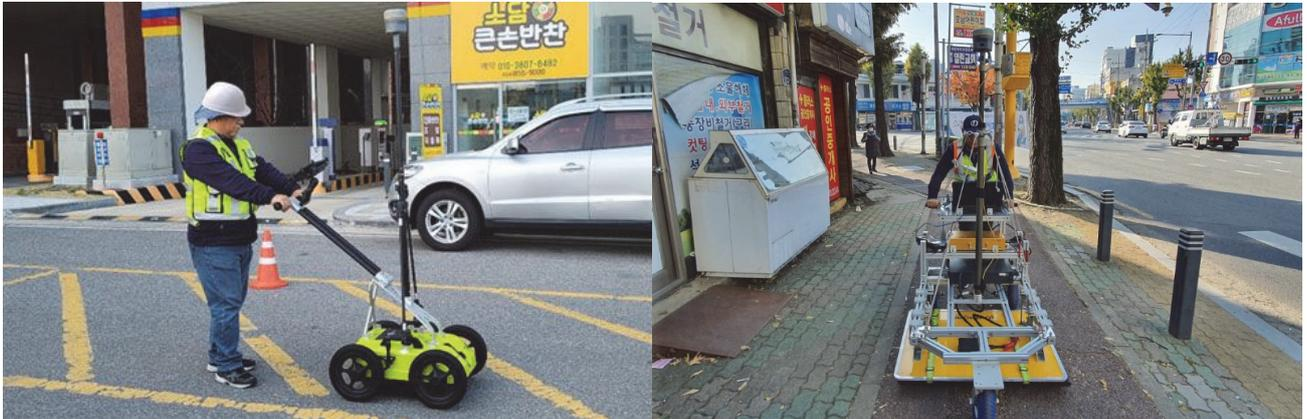
[그림 3.4] 핸디형 지표투과레이더(GPR) 탐사장비(예시)
