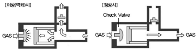
**그림** 안전기 설치(예)
