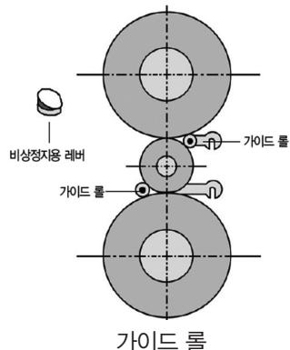
**그림** 롤러기의 롤 전면에 방호율 설치(예)
